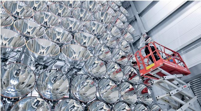
**H**undertneunundvierzig Xenon-Kurzbogenlampen, jede einzelne kann die Projektion in einem großen Kinosaal übernehmen. Fokussiert auf einer Fläche von 20 mal 20 Zentimetern erreichen die Strahler die 10.000 fache Intensität der Solarstrahlung auf der Erde.
