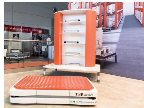
mit anderen Einheiten in einer Mensch-Maschine-Interaktionsumgebung. TORsten benötigt keinen Leitreechner zur Navigation und kann per Schwarmintelligenz Arbeitsaufträge effizient erfüllen. In Halle 16 an Stand A04 zeigt er, was er kann.
